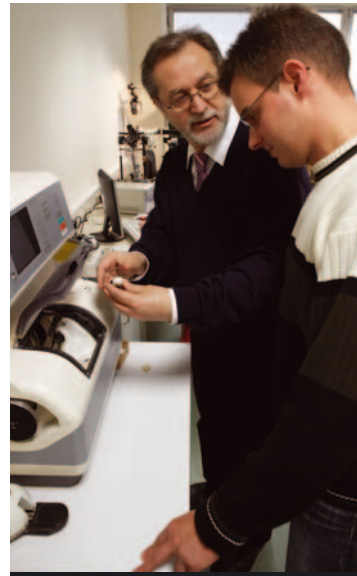
Ausbilder Claus Bohlen erklärt einem Umschüler die "Nidek 3D", eine vollautomatische Schleifmaschine für Brillengläser
