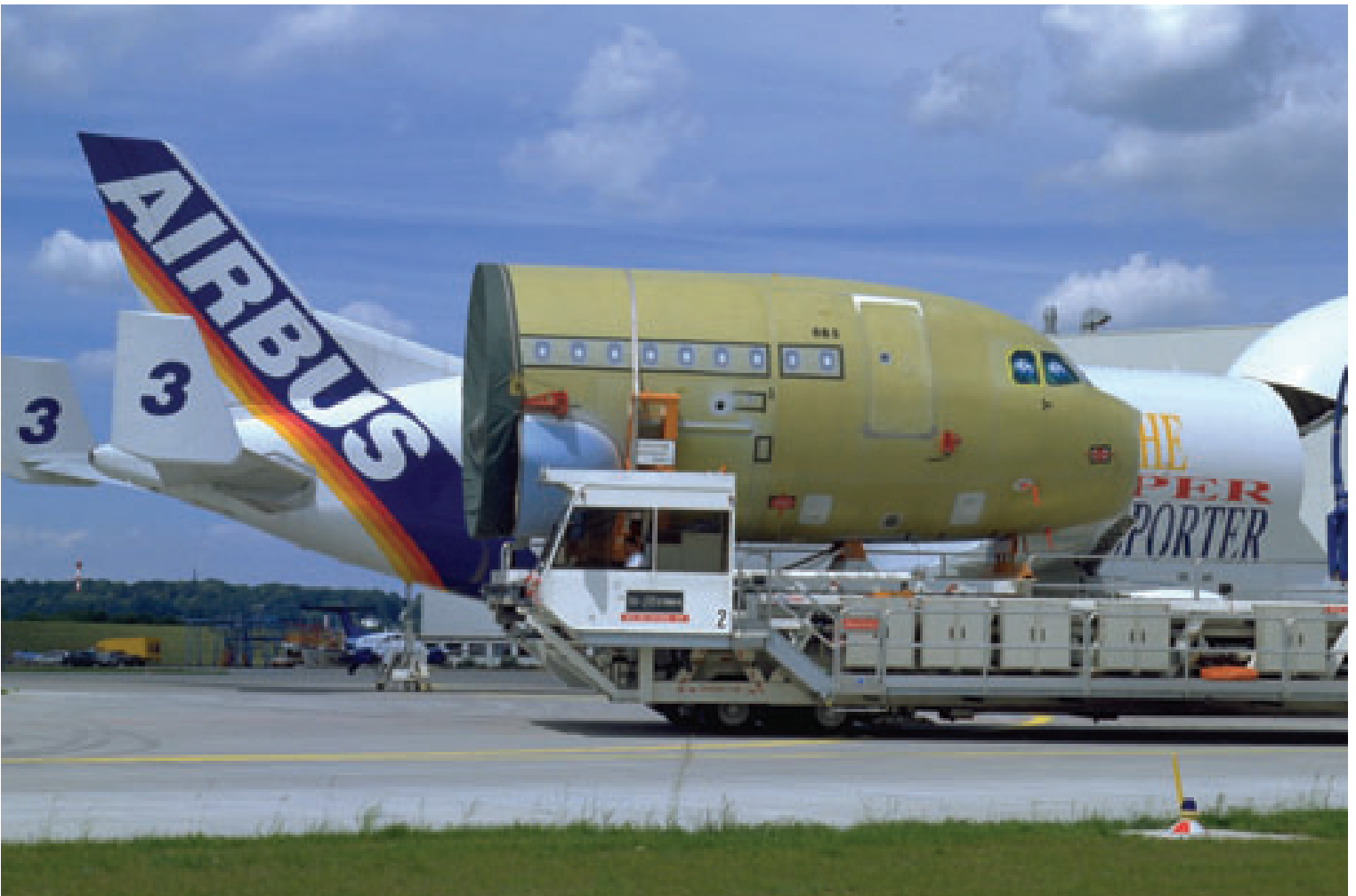
Rumpfteile der Airbus-Familie werden zwischen den einzelnen Airbus-Standorten mit dem "Beluga", einem speziell entwickelten Transportflugzeug befördert. Airbus hat zurzeit vier der Großraumtransporter im Einsatz
