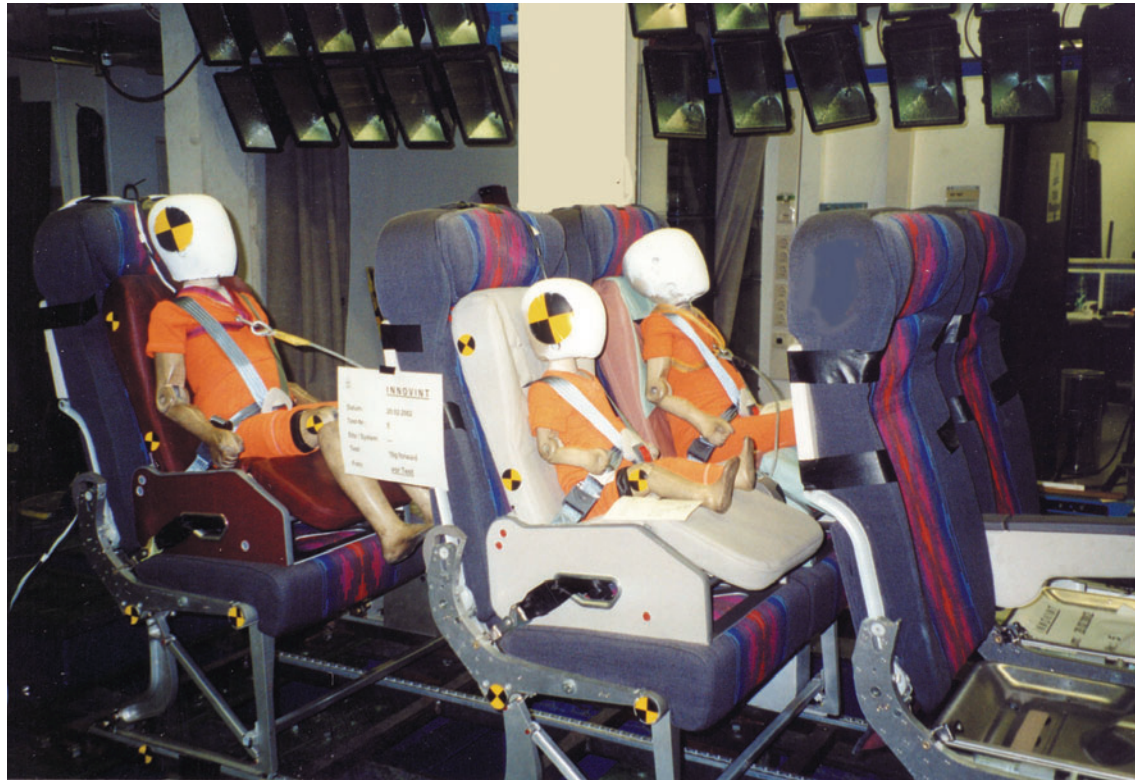
Die Innovint Aircraft Interior GmbH aus Hamburg entwickelt u. a. Flugzeugkindersitze. Im Bild sehen wir einen Dummy-Crashtest der aktuellen Kindersitz-Serie FOTO: INNOVENT
